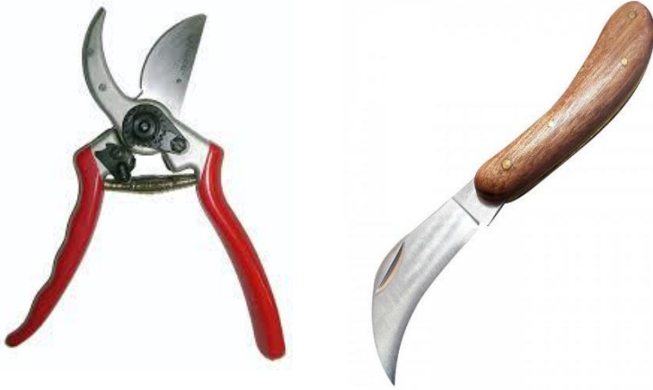
Şəkil 24. Tutun vegetativ çoxaldılması zamanı istifadə edilən alətlər: 1-bağ qayçısı; 2-bağ bıçağı; 3-calaq bıçağı
